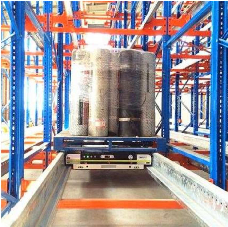
Figura 28. Rieles y transporte pallet shuttle.
