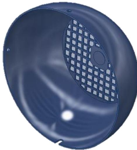
Figura 5.5. Protector del ventilador.
