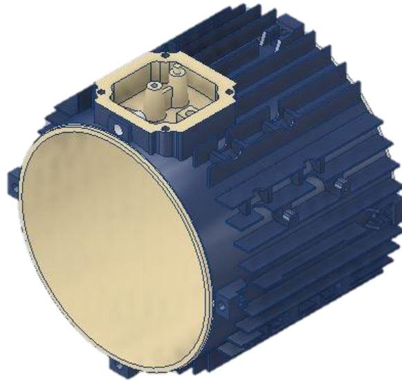
Figura 5.1. Carcasa del motor modelada en Inventor.
