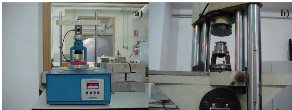
Figura 4.15. Prensas utilizadas en los ensayos: a) flexión; b) compresión.
