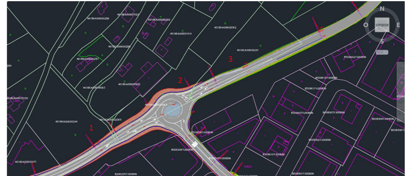
FIGURA 72. DISTRIBUCIÓN EN PLANTA DE LAS PARCELAS A EXPROPIAR ALT Nº3 (FUENTE: PROPIA CIVIL 3D)
