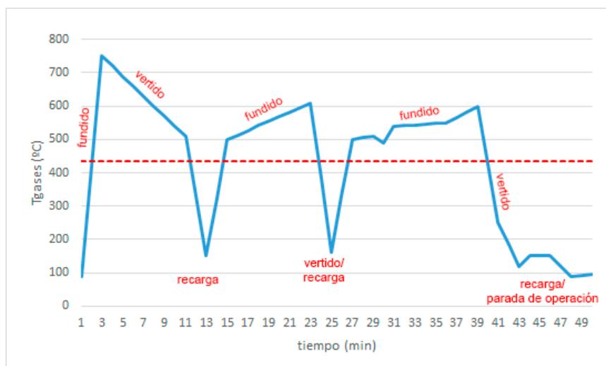
Figura 22. Ciclo TTT del gas con cada proceso diferenciado.
