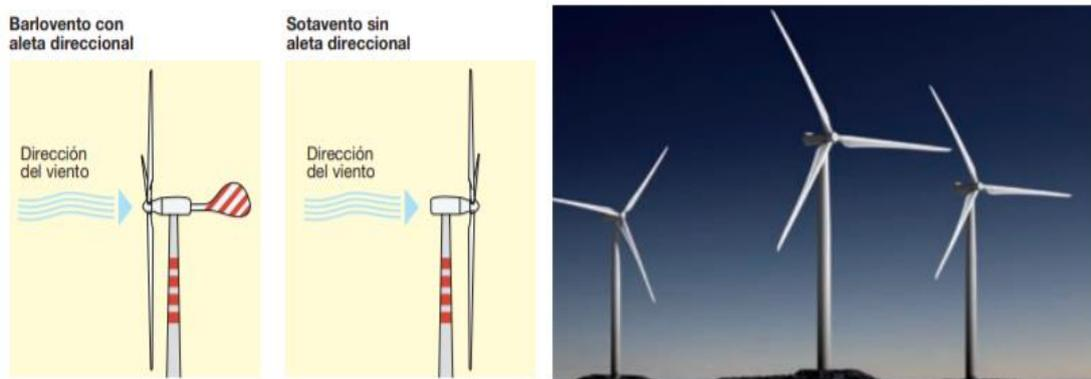
Figura 10. Aerogeneradores de eje horizontal de 3 palas. (Asea Brown Boveri, S.A, 2012)
