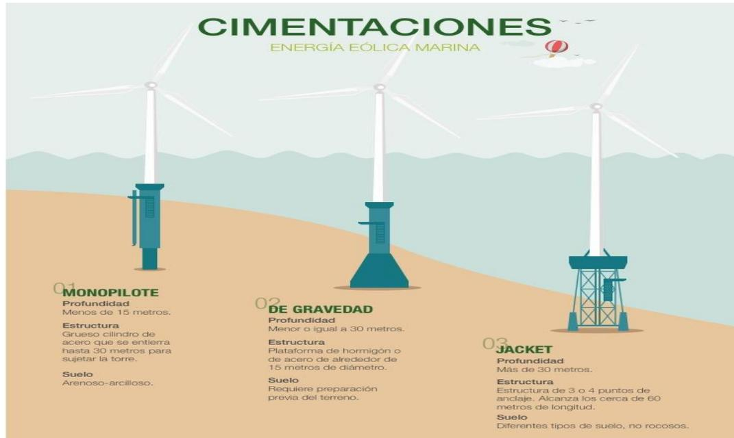
Figura 17. Tipos de cimentación fija. (Iberdrola, 2021)
