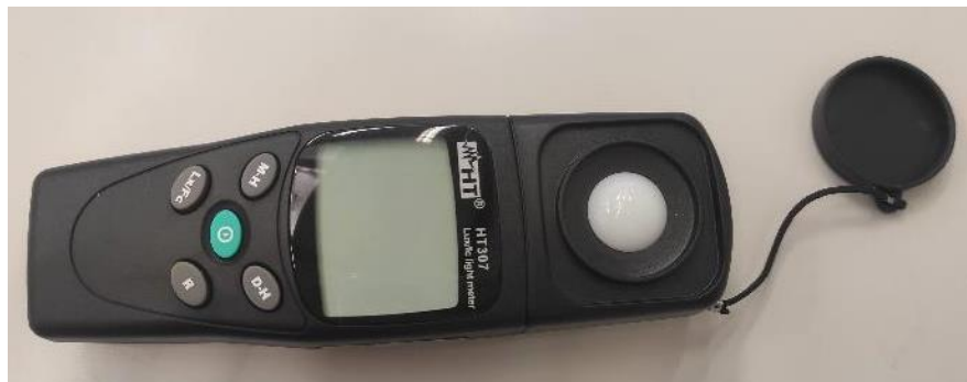
Figura 23. Luxómetro utilizado. 2021. Fuente propia
