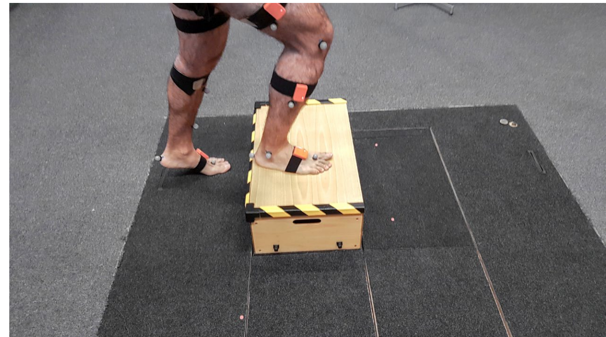
Figura 5. Estudio de la sensibilidad de los sensores inerciales frente a la fotogrametría durante el gesto de pasar un escalón.
