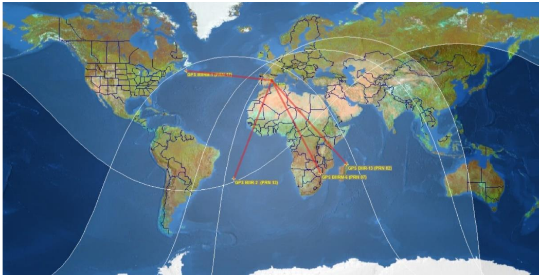
Ilustración 41. Mapa rectangular con la HDOP de los satélites del primer caso
