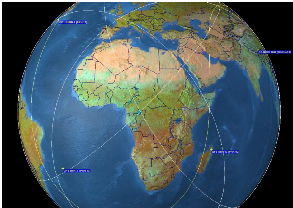
Ilustración 44. Mapa tridimensional de cobertura de los satélites del segundo caso
