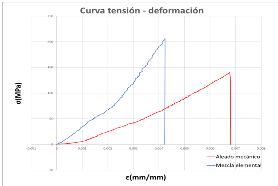
Figura 28: Curva tensión- deformación de la aleación TNZT para ambas técnicas pulvimetalúrgicas.
