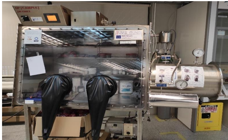
Figura 12: Cámara de guantes con atmósfera controlada por argón.
