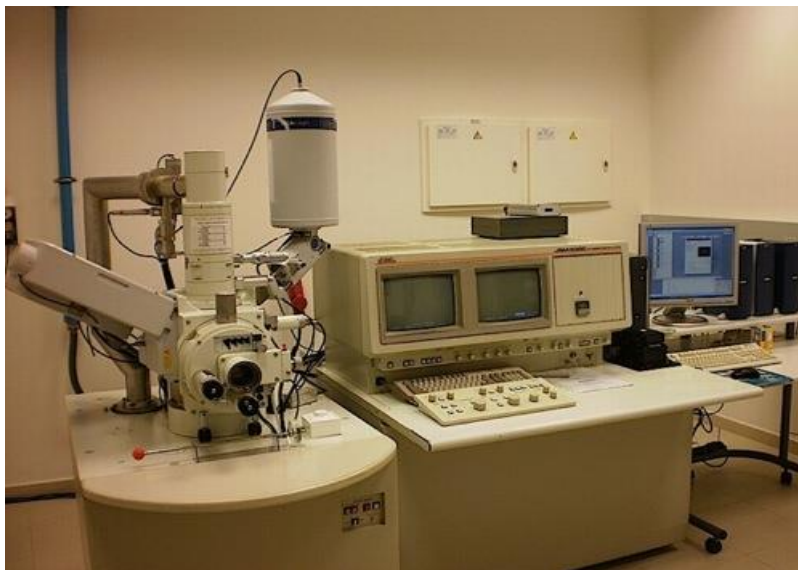
Figura 25: Microscopía electrónica de barrido (SEM). Normativa (ASTM E112-13, 2013).
