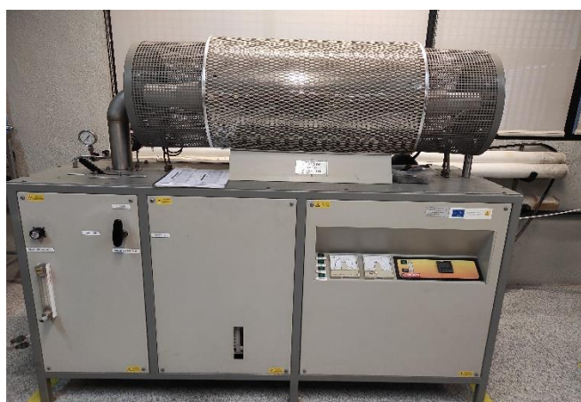
Figura 17: Horno de alto vacío de Carbolite donde se llevó a cabo la sinterización de las aleaciones.
