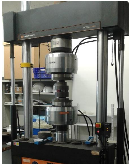
Figura 15: Montaje de ensayo de compactación.
