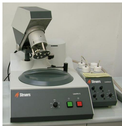
Figura 23: Pulidora Struers modelo Labapol 5.
