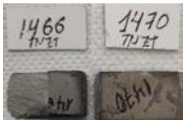
Figura 20: Trozos de las muestras después del ensayo de flexión.
