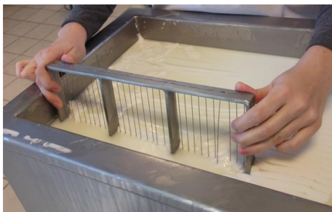
Figura 9. Operació de tallar la quallada mitjançant lira manual
