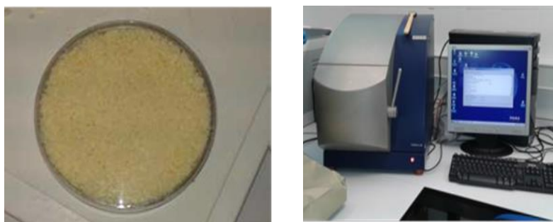
Figura 13. Anàlisi de composició del formatge (NIRS FoodScan, Foss)
