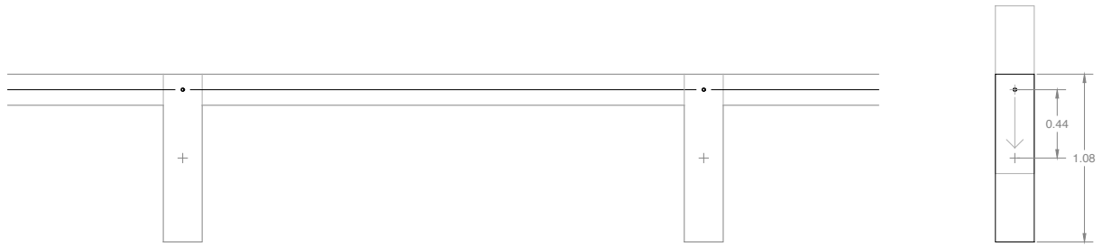
Figura 33. Modelización de los nervios como barras con sección descentrada. Cotas en metros. [Dibujos del autor]
