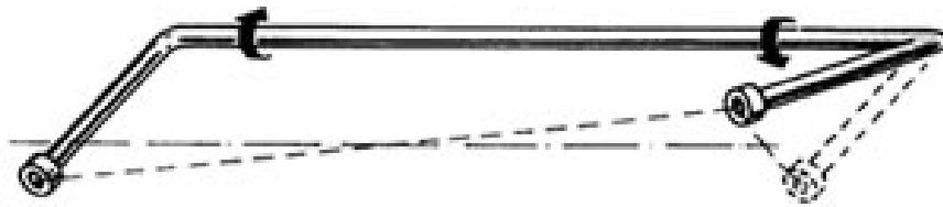
Figura III.7. Representación esquemática del comportamiento y las solicitaciones de una barra estabilizadora.
