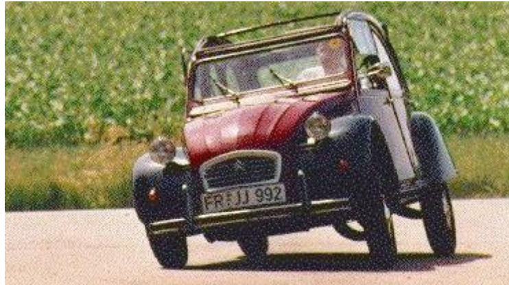
Figura I.30. Representación del balanceo de un vehículo durante el paso por curva.
