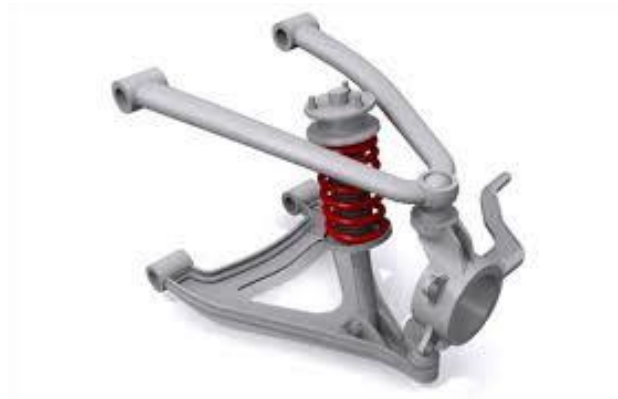
Figura I.23. Representación esquemática de los principales componentes de suspensión independiente delantera de paralelogramo deformable.
