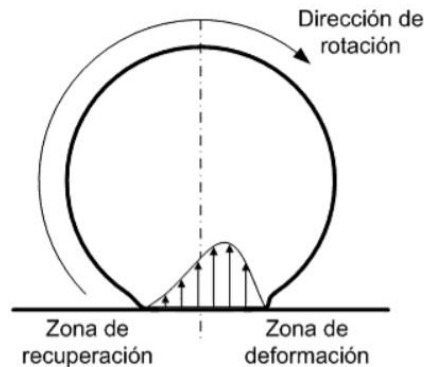
Figura III.8. Representación gráfica del desplazamiento de las fuerza de reacción en el neumático en situación de avance.
