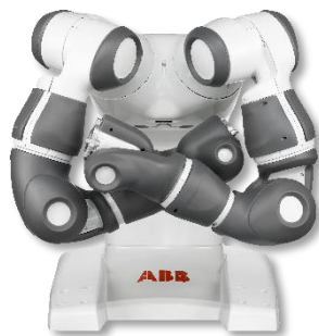
Figura 11. Robot colaborativo Yumi con dos brazos articulados de 7 ejes de la casa ABB.
