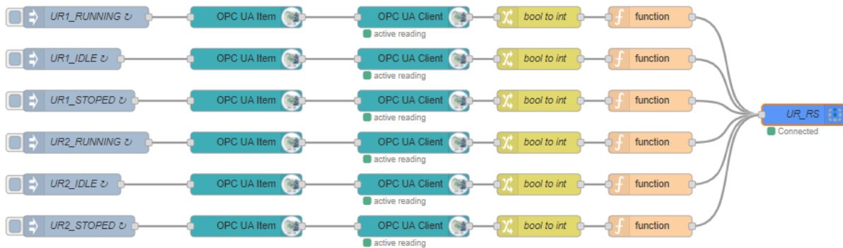
Figura 138. Programación gráfica para mostrar en el Dashboard de UBIDOTS el estado de funcionamiento de ambos robot UR.
