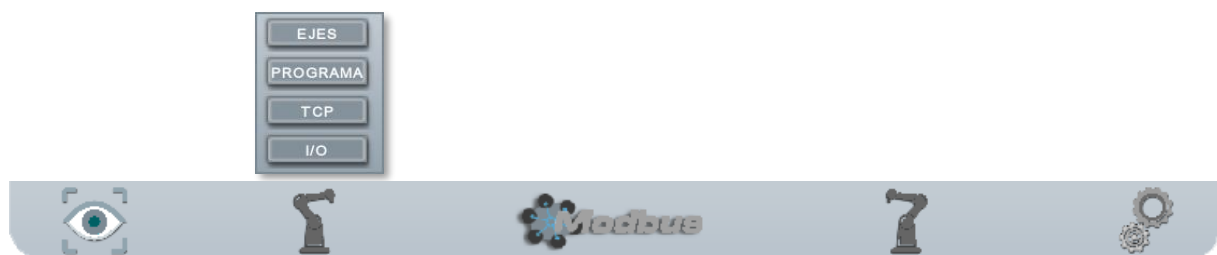
Figura 113. Menú principal y secundario para navegar por el HMI.
