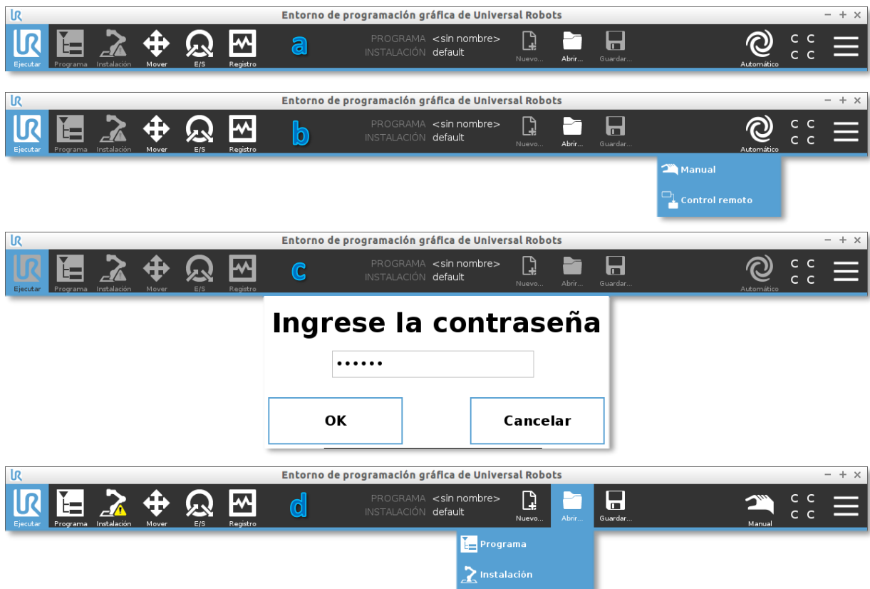
Figura 11. Secuencia para cargar los ficheros de configuración de la estación y el programa para cada unidad.
