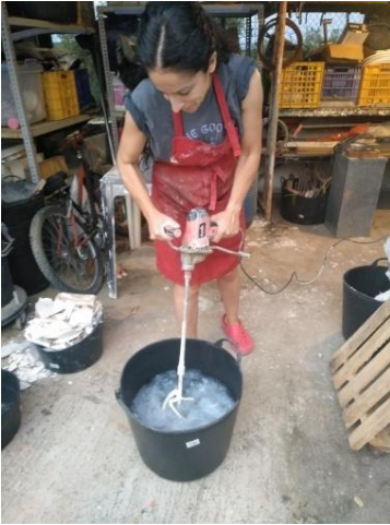
Fig.43.SILVIA P.Colada en escayola y fibra de vidrio.
