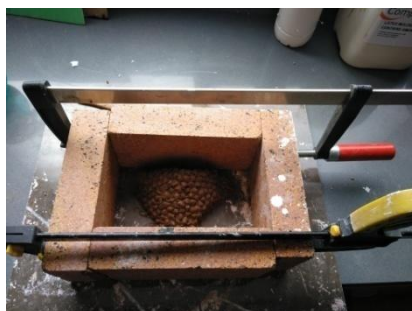
Fig.50.SILVIA P.Elaboración molde nido con látex prevulcanizado.
