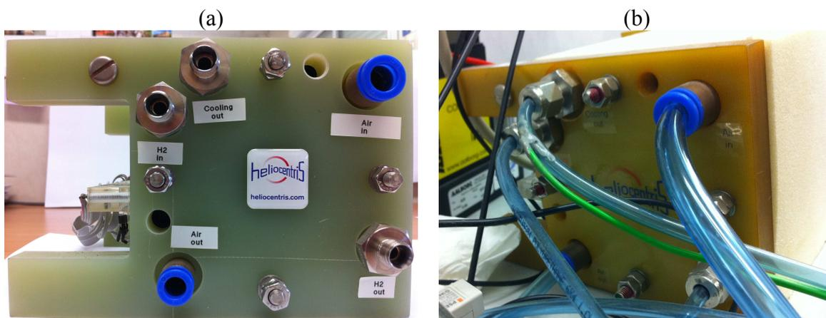
**Figura III.4:** Conexiones de entrada y salida de los gases y del agua de refrigeración.
