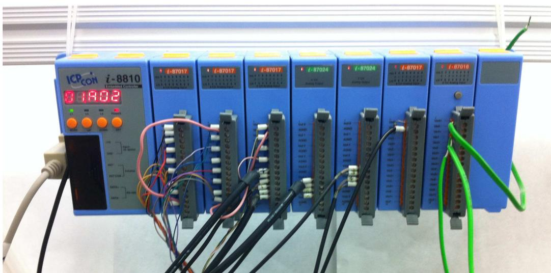
*Figura III.6:* Módulo de adquisición de datos.
