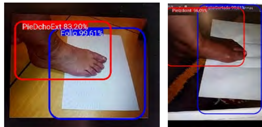
Figura 2. Capturas de pantalla del proceso de detección de pies y folios en imágenes en tiempo real. Izquierda: pie derecho exterior. Derecha: pie izquierdo interior.
