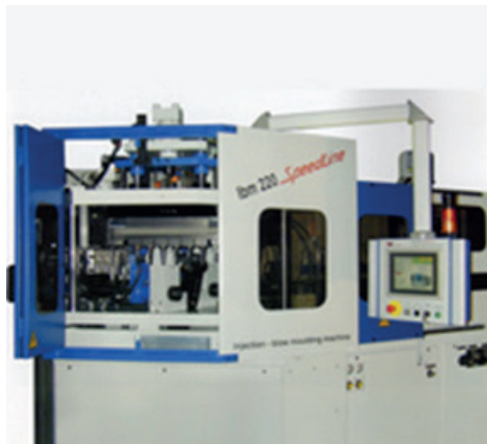
Imagen 49. Máquina de inyección/soplado.
