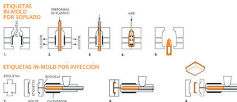
Imagen 52. Etapas de la fabricación por soplado.
