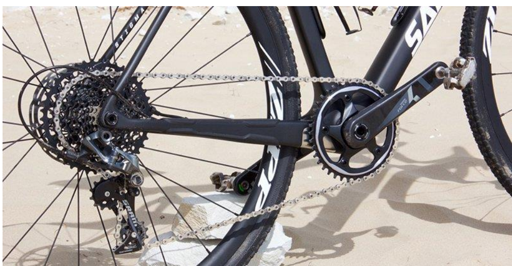
Figura 13. Detalle de una transmisión con monoplato en una bicicleta de carretera.
