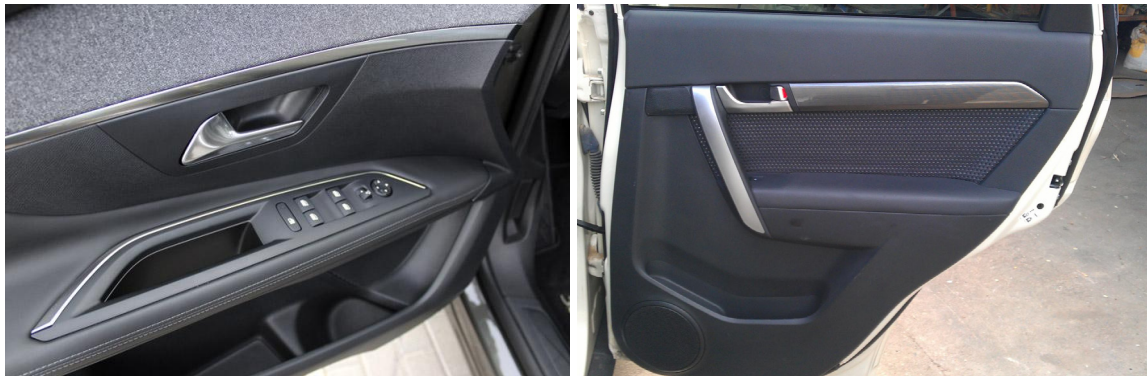
Figuras 26 y 27: Paneles con asideros horizontal y diagonal
