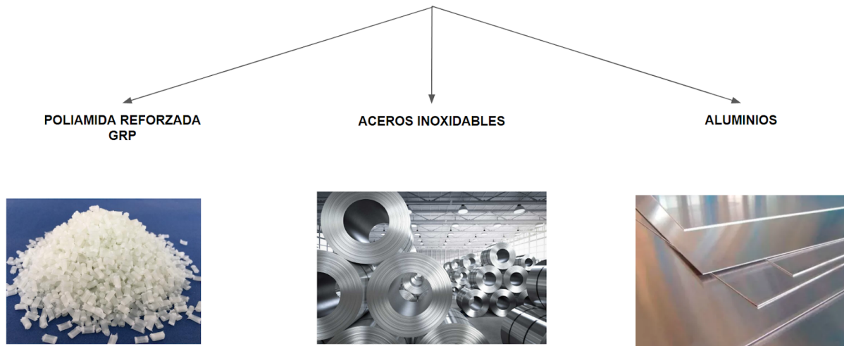
Imagen 17_10: Materiales para aparamenta eléctrica en zonas ATEX
