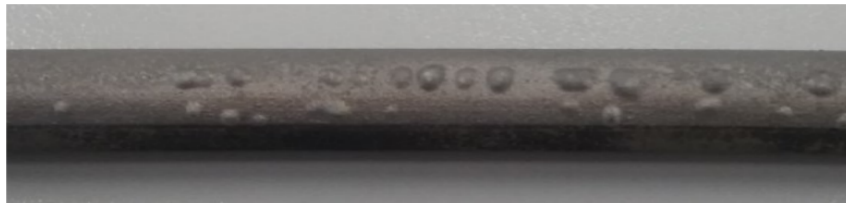
Imagen 17_13: Tubo de aluminio deteriorado por la difusividad del hidrógeno
