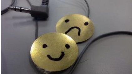
Fig. 42 Micrófonos piezoeléctricos en estéreo.
