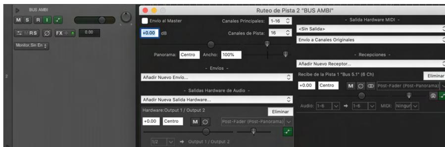
Figura 4.7: Bus de Reaper para el procesado de audio en Ambisonics.
