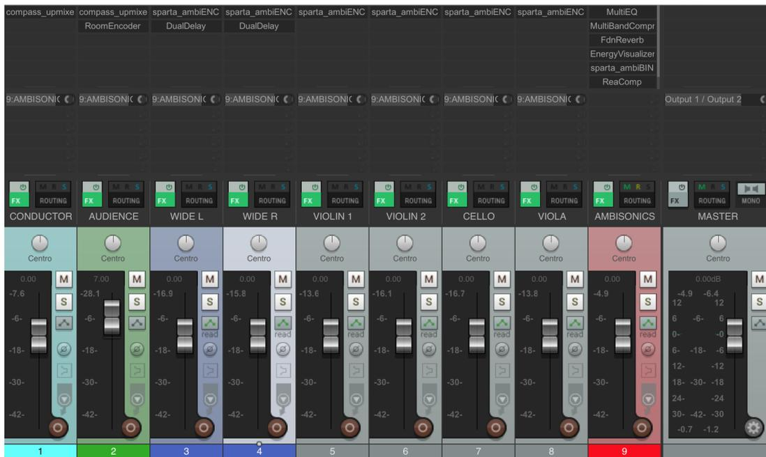
Figura 5.2: Mezclador con los *plugins* insertados, los colores del diagrama y el bus *Ambisonics* general.
