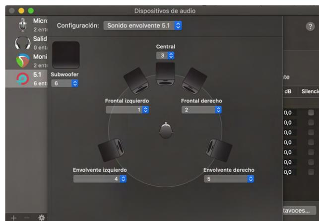
Figura 4.3: Configuración del orden de canales del sistema 5.1.
