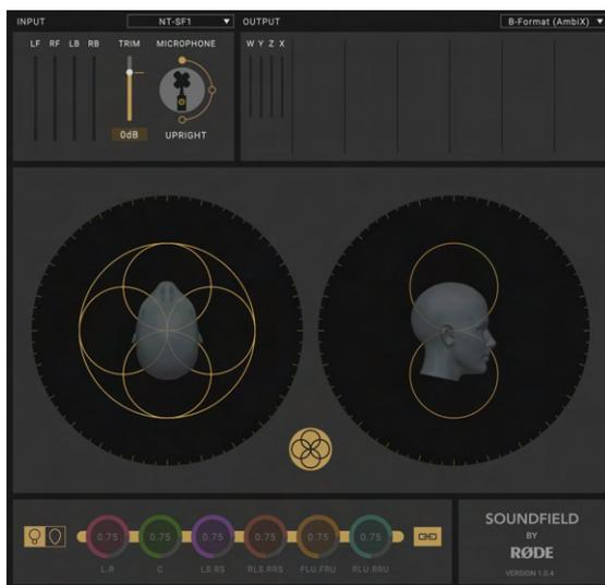
Figura 4.30: VST del *Rode NT-SF1*. para manejo y conversión entre formatos. Incluye decodificación.
