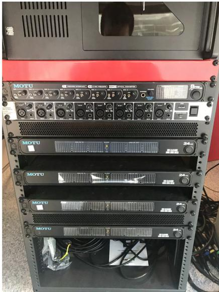
Figura 4.17: Vista frontal del rack con las 4 tarjetas MOTU 24I/O.
