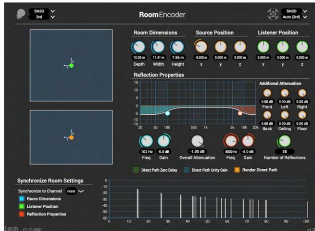
Figura 5.3: *Room Encoder* del paquete IEM para codificación de una fuente Ambisonics dentro una sala.
