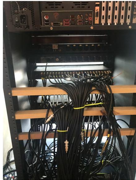
Figura 4.18: Vista trasera del rack con las 4 tarjetas MOTU 24I/O y el cableado necesario.
