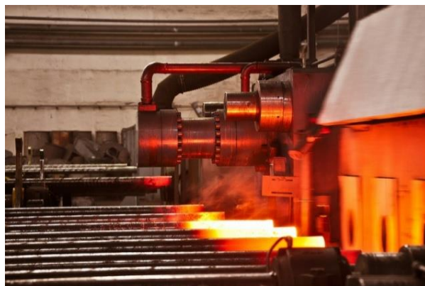
Imagen 45: Proceso extrusión de metales. Fuente: Google.com
