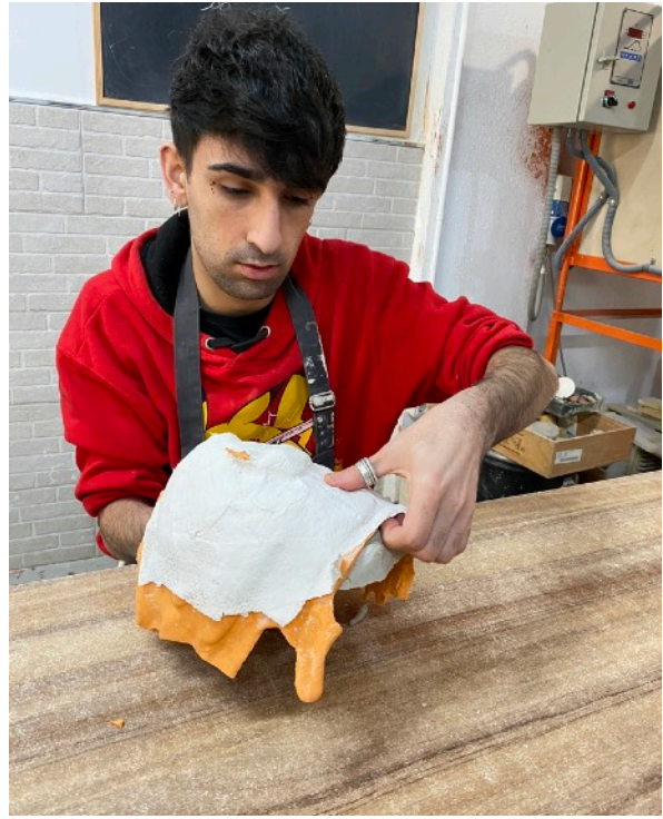
11. Extracción del molde positivo del rostro en escayola
