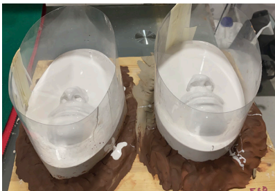
Fig. 34. Encofrado y vertido de silicona.
