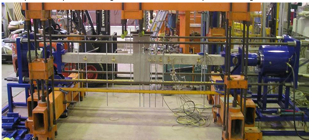
Figura 10 Disposición de los soportes ensayados dentro del pórtico de carga
