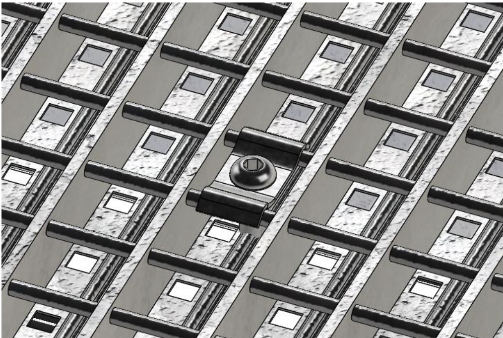
Figura 19: Unión piso- estructura portante
