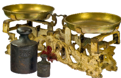
Figura 13. Balanza de Roberval datada en el año 1920.
