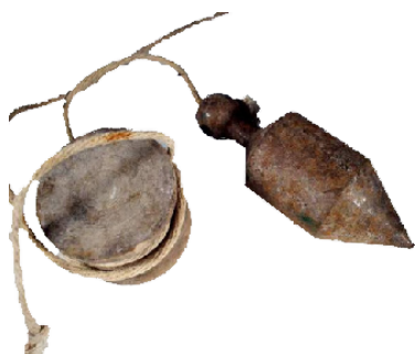
Figura 4. Las plomadas empleadas para las balanzas provenían de invenciones como esta plomada antigua para construcción.
