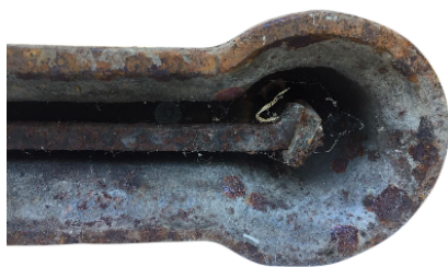
Figura 66. Depósitos biológicos acumulados en el interior de la base.
