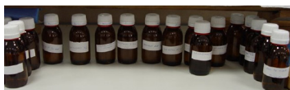
Figura 63. Disoluciones del test de Wolbers separadas según las proporciones y relaciones indicadas en la figura anterior.
