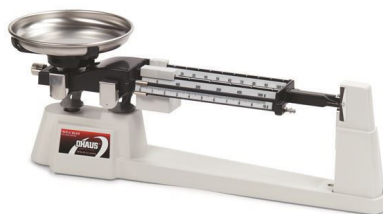
Figura 20. Balanza granataria con pesos deslizantes.
