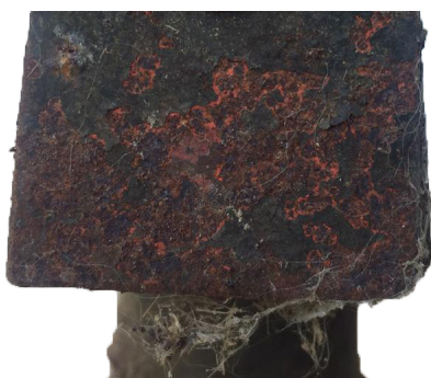
Figura 57. Producto de corrosión contemplado como hematita.
