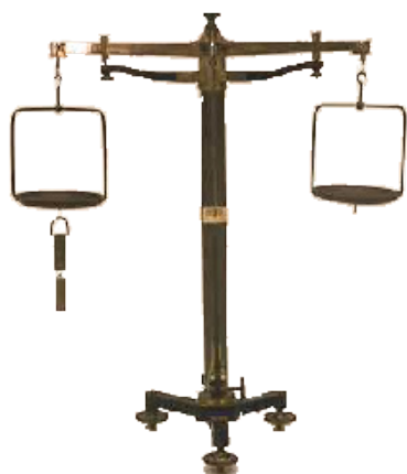
Figura 18. Balanza hidrostática del siglo XIX.
