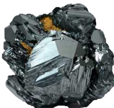
Figura 39. Mena de hematita, fuente mineral para la obtención de hierro.
