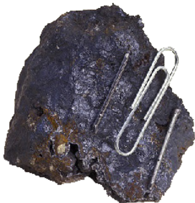
Figura 43. Prueba de magnetismo con clip de aluminio sobre un fragmento de magnetita.
