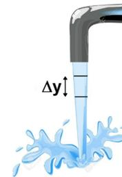
Figura 4 – Cañería con elemento de fluido representado fuera de la misma.
