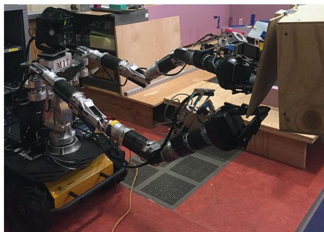
Figura 2.5: Prototipo de robot desactivador de bombas del MIT[5].
