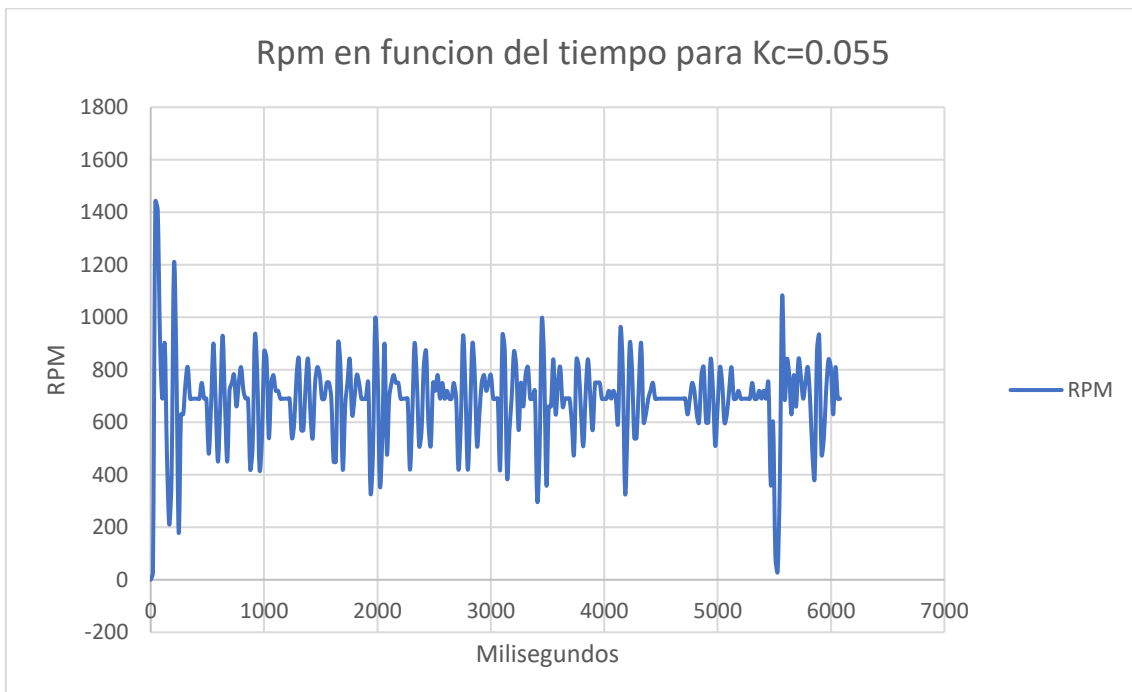
Figura 46 Toma de datos para K_c=0.055
