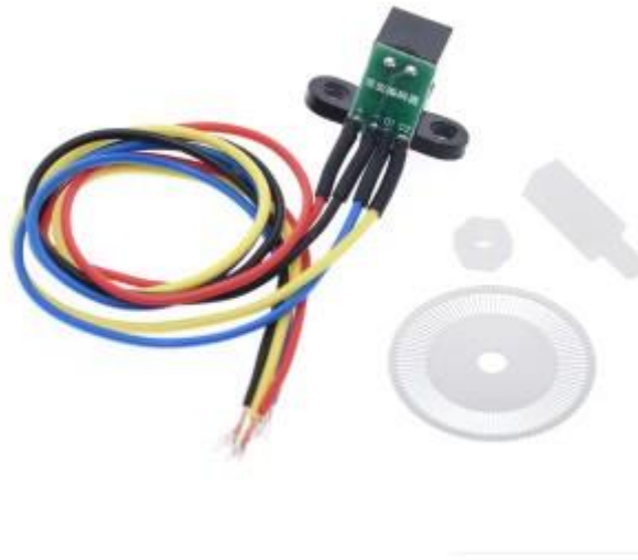
Figura 4 Encoder de cuadratura. Fuente: [7]
