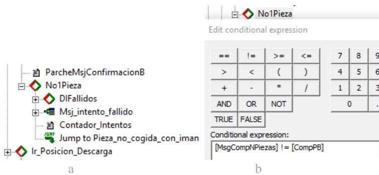
Imagen 59: Tarea “No1Pieza” desplegada (a). Condición tarea “No1Pieza” (b)
