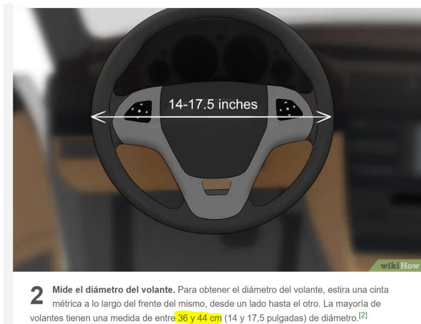
Figura 13. Explicación de cómo medir un volante el diámetro exterior del volante. Imagen donde te muestra el modo de medir un volante para pedir una funda para este. Además, se puede observar el rango de dimensiones que tienen los volantes. Adaptación de ( Cómo Poner Una Funda Para Volante , n.d.)
