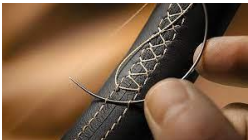
Figura 87. Trenzado para fijar la funda al volante. Imagen donde se muestra el trenzado que se debe realizar a la funda del volante para que ésta quede bien fijada al volante. ( Costuras Artesanales En El Forro Del Volante de Cuero. , n.d.)
