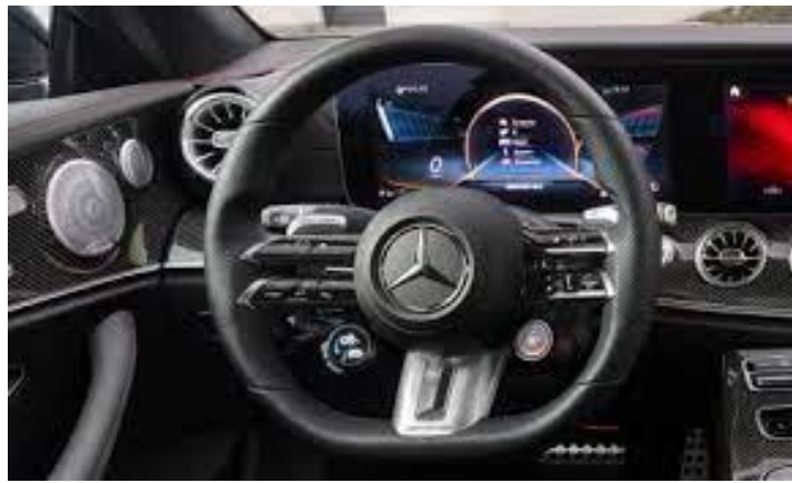
Figura 20. Volante del Mercedes Clase E coupé. Imagen donde se puede observar la zona recta que se empieza a incorporar en algunos modelos para aumentar el espacio disponible para el conductor. Adaptación de (No Title, n.d.-b)
