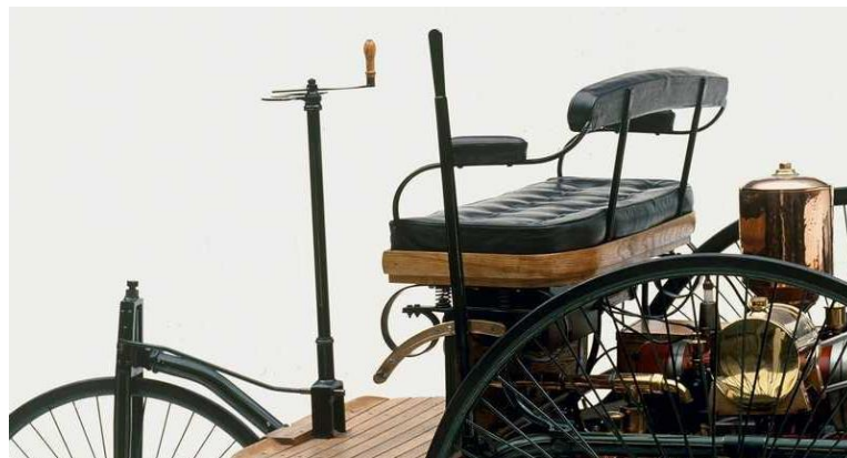
Figura 3. Imagen del Patent-motorwagen. Imagen donde se puede observar la configuración del sistema de dirección y la configuración del volante. ( Benz Patent-Motorwagen (1886) , 2020)
