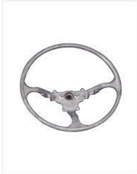
Figura 10. Núcleo metálico de un volante. Imagen donde se muestra el esqueleto metálico de un volante de coche. (No Title, n.d.-a)
