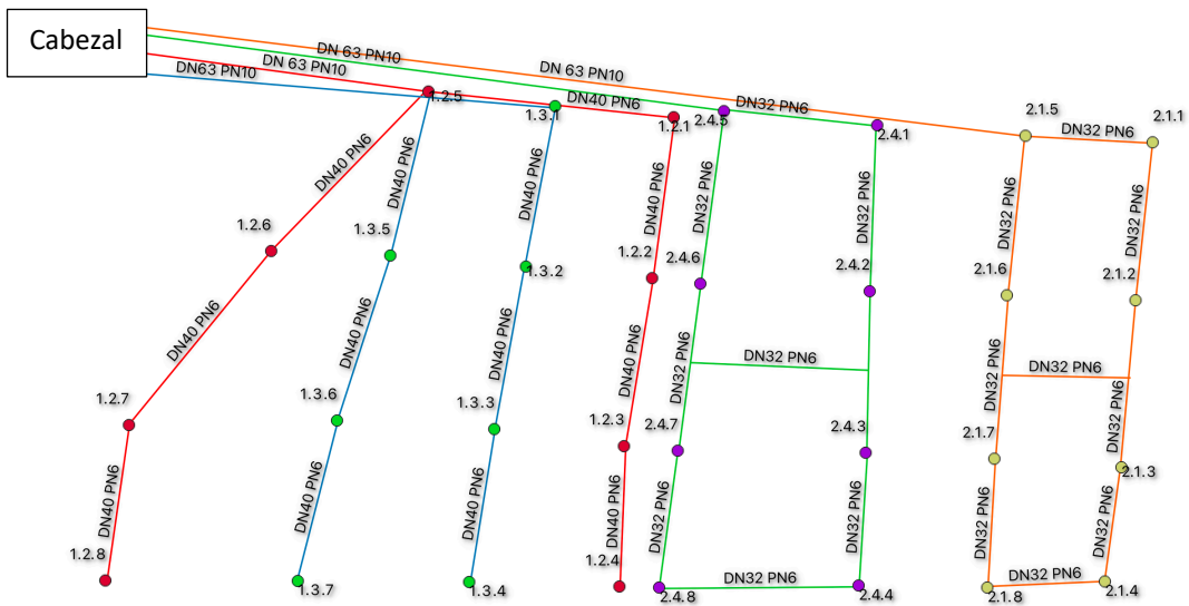
Figura 5. Distribución de las tuberías y aspersores en las parcelas 1 y 2.
