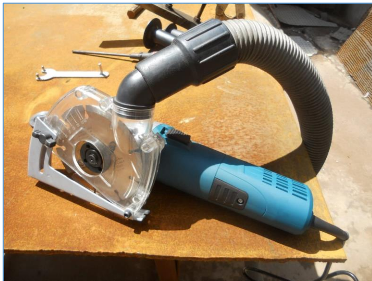
Imagen 23. Radial con sistema de extracción mecánico de polvo.
