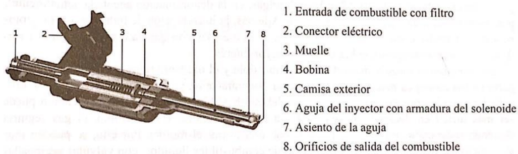
Figura 2.6 Partes que conforman el inyector. Fuente: (Desantes, Payri [1])
