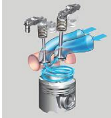
Figura 2.1 Efecto Swirl en el interior de la cámara de combustión. Fuente: https://www.nissan-global.com/JP/TECHNOLOGY/FILES/m9r.jpg
