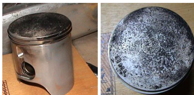
Figura 2.10 Imagen de un pistón deteriorado por picado de biela. Fuente: Internet
