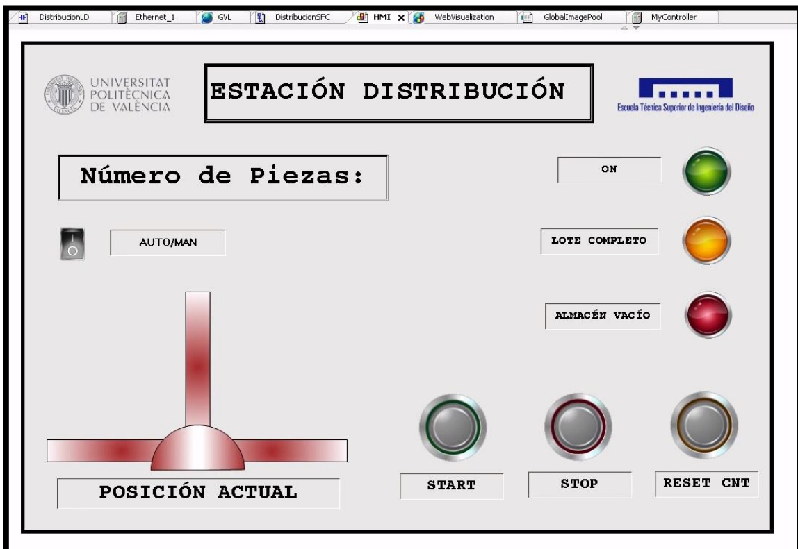
Ilustración 21. HMI de la Estación de Distribución
