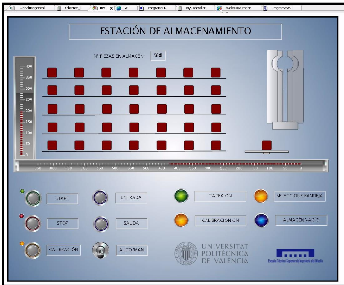
Ilustración 39. HMI de la Estación de Estanterías Altas
