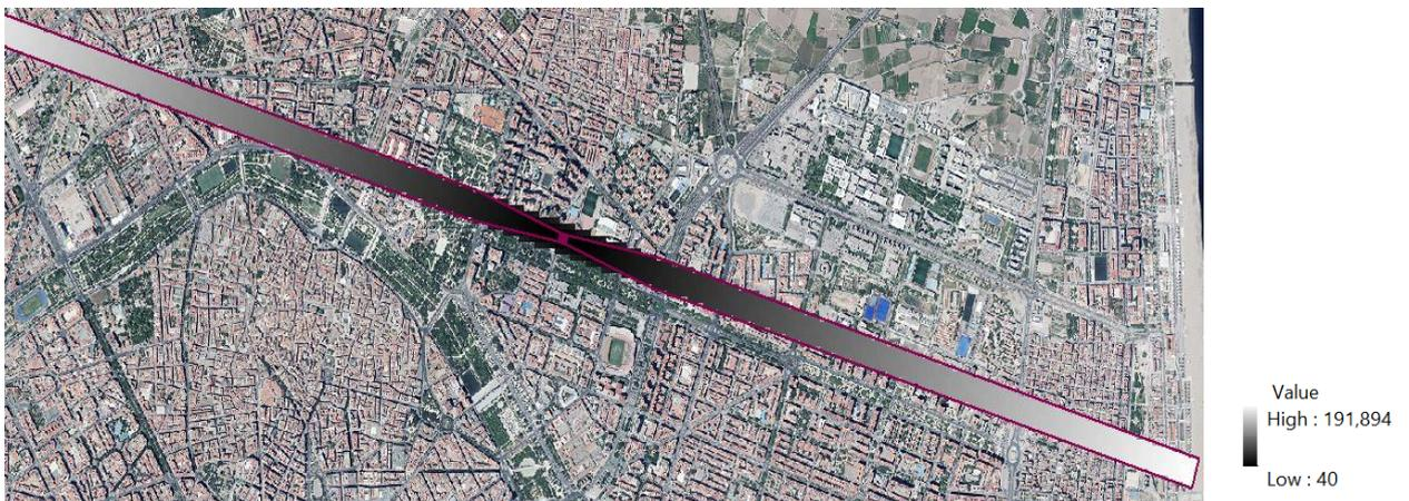
Figura 23 Superficies de aproximación y ascenso en el despegue en formato Raster.
