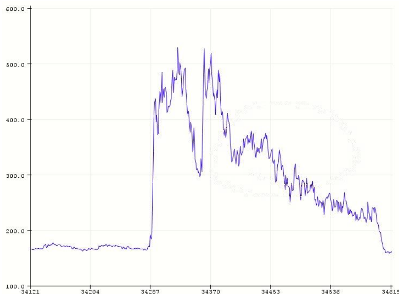
Figura 45. Captura de pantalla del senyal enregistrat per l'Arduino amb un període de mostreig de 20 ms
