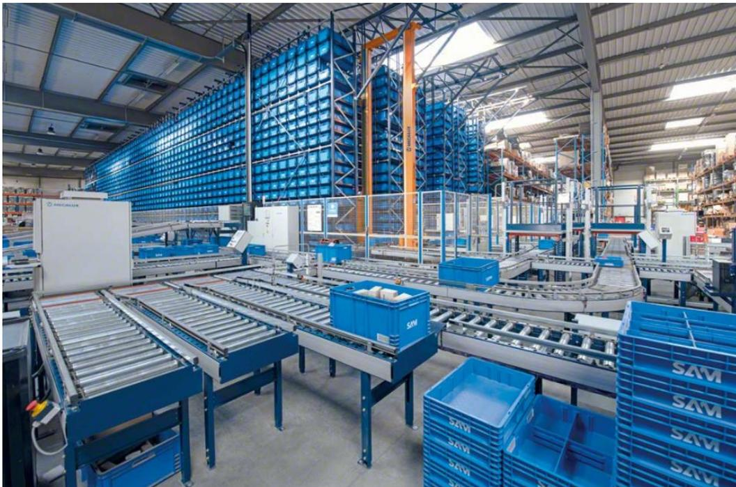
FIGURA 51. EJEMPLO ALMACÉN AUTOMÁTICO CON CINTA DE RODILLOS PARA EXTRACCIÓN DE CAJAS. FUENTE: (MECALUX ESMENA, 2021)
