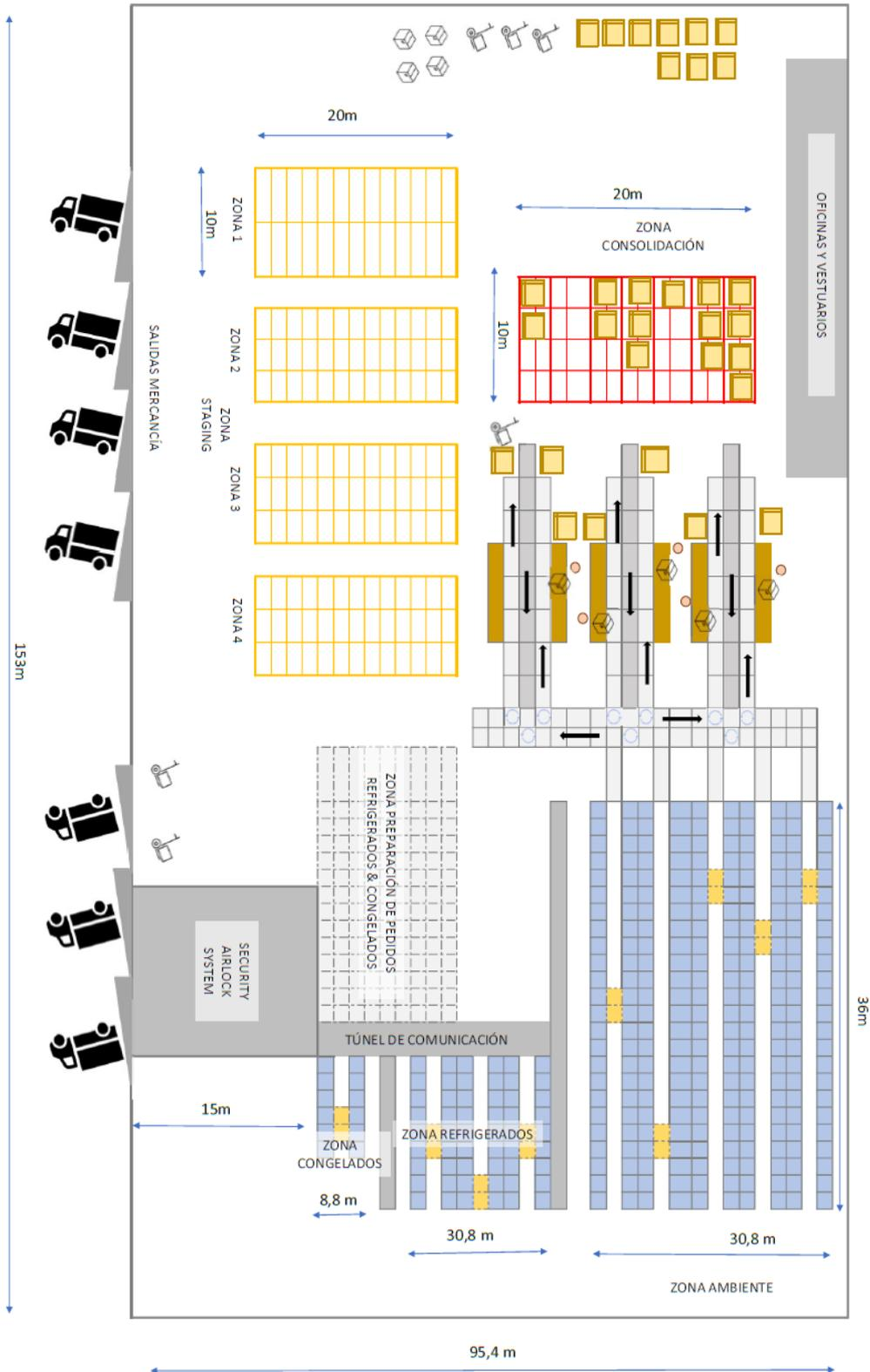
FIGURA 55. LAYOUT DEL CENTRO DE DISTRIBUCIÓN PROPUESTO EN EL TERCER ESCENARIO. FUENTE: ELABORACIÓN PROPIA
