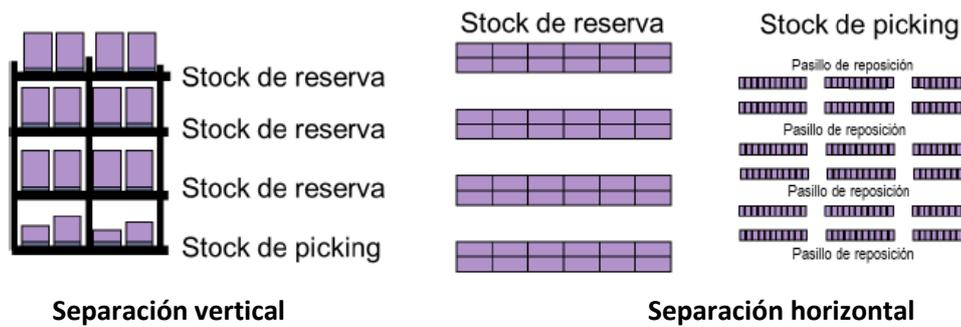
FIGURA 17. SEPARACIÓN VERTICAL U HORIZONTAL ENTRE PICKING Y RESERVA. FUENTE: (GARCIA-SABATER, 2020)
