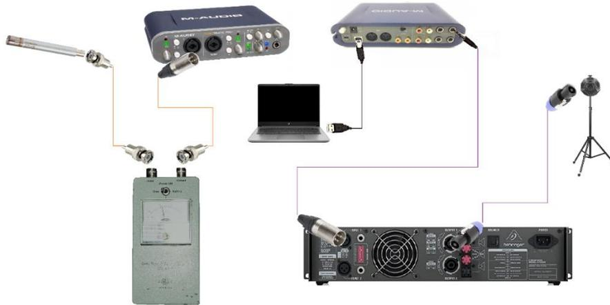
Figura 21: Conexión para la medición de la respuesta al impulso
