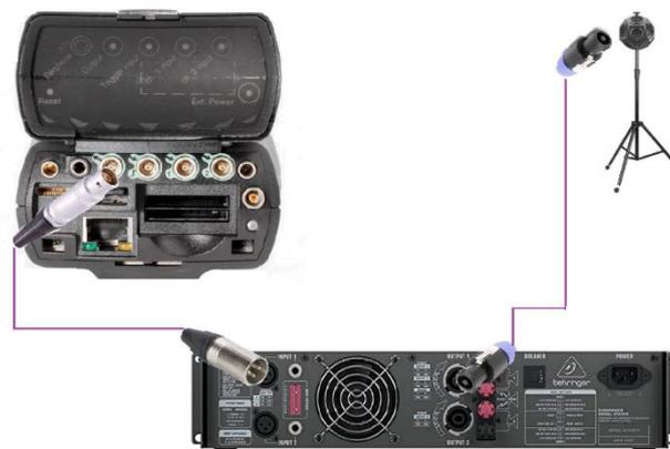
Figura 22: Conexión para la medición del tiempo de reverberación
