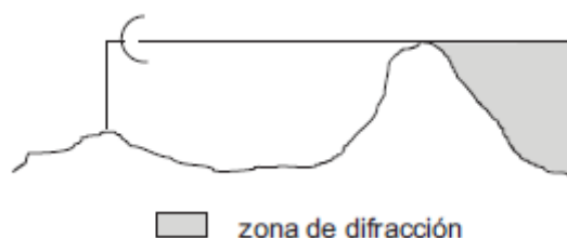
Figura 2.7: Obstrucción causada por la tierra [10].
