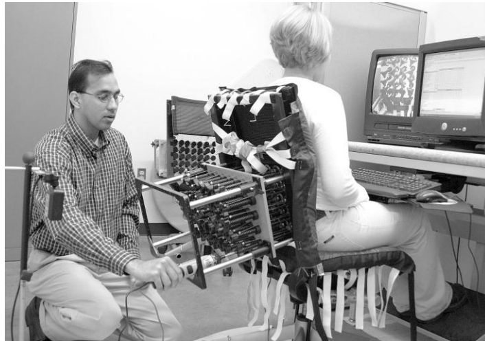
Figura 8. Ensayos sobre distintas posiciones de la silla. Haworth
