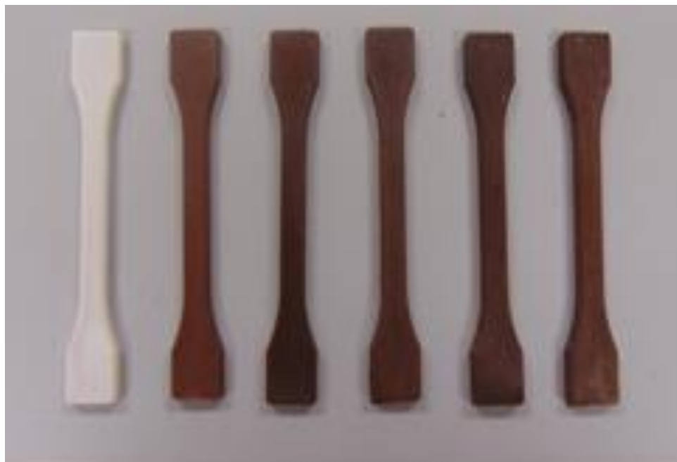
Figura IV.2.2. Probetas de tracción tipo IBA obtenidas mediante inyección con un 30 % en peso de cáscara de almendra variando el tamaño de partícula. De izquierda a derecha: TPS, biocomposite con tamaños de partícula <0.05 mm, 0.05-0.08 mm, 0.08-0.125 mm and y 0.125-0.250 mm.
