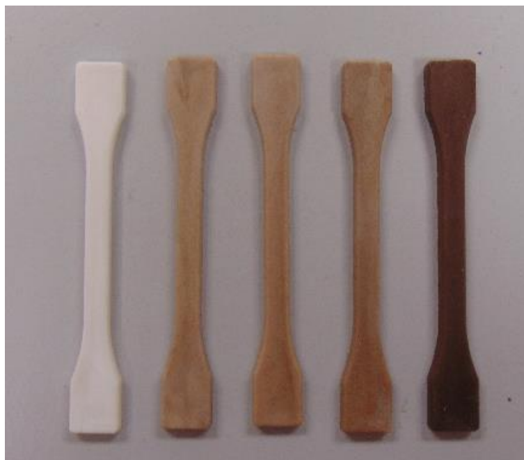
Figura IV.2.6. Probetas de tracción tipo IBA obtenidas mediante inyección variando el contenido de cáscara de almendra. De izquierda a derecha: TPS, Biocomposite 5 % ASP, Biocomposite 10 % ASP, Biocomposite 20 % ASP y Biocomposite 30% ASP.
