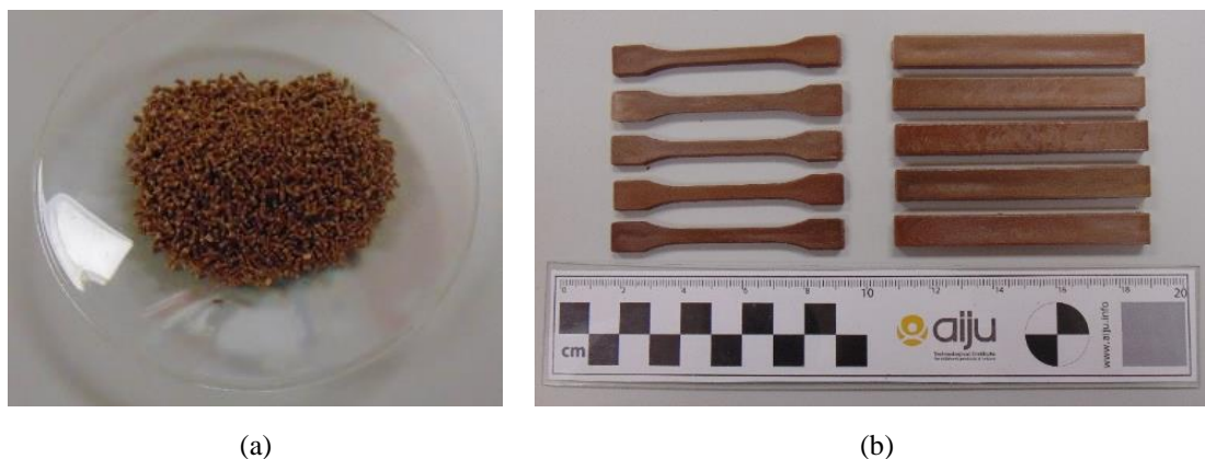
Figura IV.1.8. (a) Granza obtenida mediante extrusión de TPS con 30 % en peso de cáscara de almendra; (b) Probetas normalizadas tipo 1BA obtenidas mediante inyección a partir de la granza extruida.
