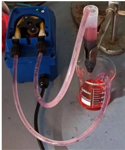
**Figura 6.** Sistema de recirculación de la columna
