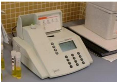
**Figura 7.** Medidor de la DQO
