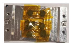
**Figura 6.5**. Portamuestras empleado para la adquisición de los espectros de absorción de rayos-X de muestras sólidas donde se aprecia la preparación y disposición de las muestras con recubrimiento de cinta de Kapton (naranja)
