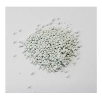
Figura 5.9. Esferas de CaA/SiO<sub>2</sub>.
