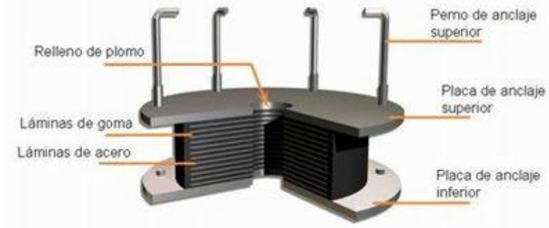
Partes de un aislador elastomérico.
