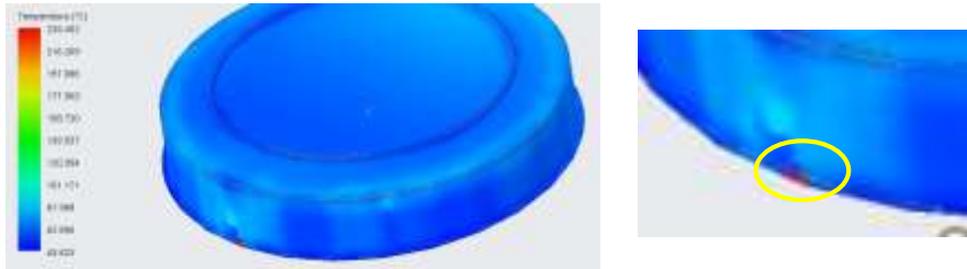
Ilustración 7-26. Degradación primer análisis de la tapa.
