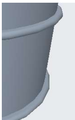
Ilustración 6-7. Redondeo de los anillos de refuerzo
