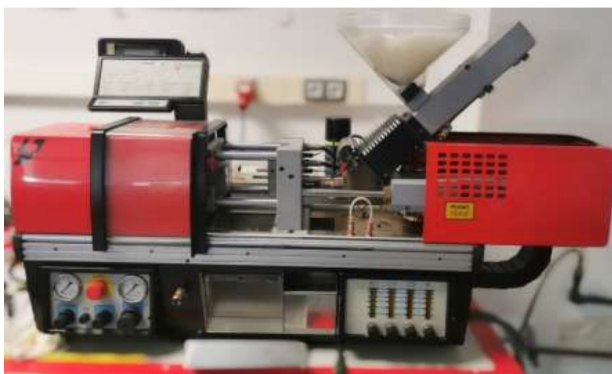
Ilustración 4-2. Máquina de inyección de plástico Babyplast 6/6
