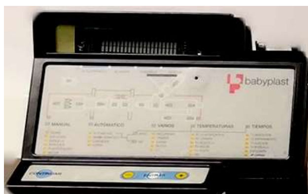
Ilustración 4-3. Panel de control de la máquina Babyplast 6/6
