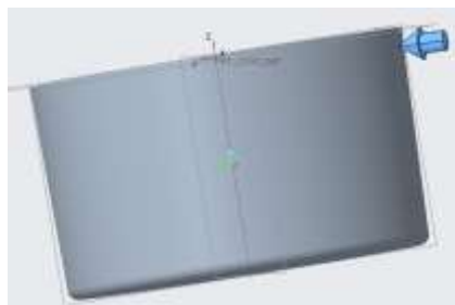
Ilustración 7-12. Punto de inyección según las canaletas diseñadas de la base
