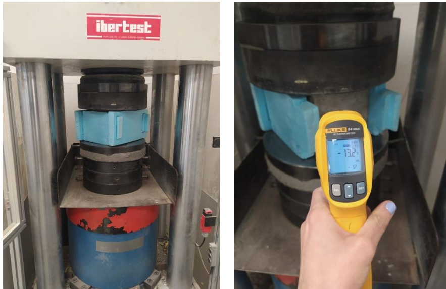
Figura 21 Ensayo de resistencia a compresión simple UNE-EN 12390, con poliestireno expandido
