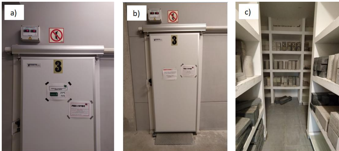
Figura 14 a) Cámara húmeda, b) probetas en conservación 98% de humedad, c) distribución de las probetas
