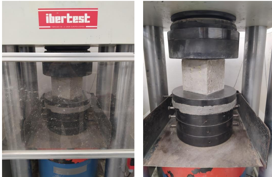
Figura 17 Ensayo Resistencia a compresión simple, Norma UNE-EN 12390.
